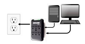
Retirez la vis du couvercle de la prise électrique. Insérez le MMS660S dans la prise électrique et fixez-le avec la vis fournie avec le MMS660S. Ensuite, branchez vos appareils au MMS660S. Vérifiez que la DEL verte « PROTÉGÉ » est activée. Si tel est le cas, le MMS660S protège activement votre équipement. Si ce voyant est éteint, le MMS660S a un défaut interne ou a absorbé un pic suffisamment important pour être endommagé et doit être remplacé.
