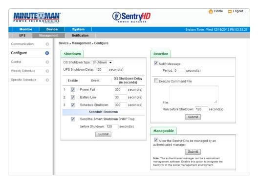
**Fermer**: Sélectionnez le type d'arrêt pour déterminer la meilleure façon d'arrêter le système d'exploitation. Les options sont Arrêter, Éteindre et Mettre en veille prolongée. La valeur par défaut est Arrêt. Sélectionnez l'événement qui déclenchera l'action d'arrêt et entrez le temps nécessaire au système d'exploitation pour arrêter. Si l'événement se rétablit pendant le compte à rebours, le processus d'arrêt sera annulé, l'hôte ne sera pas arrêté.
