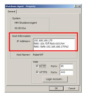
4. Accédez à la page SNMP Trap de SentryHD et entrez l'adresse IP du serveur hôte du MM ShutdownAgent dans la table SNMP Trap comme IP cible. Sélectionnez MM ShutdownAgent pour le niveau d'événement et UPSv4 comme Trap MIB.
