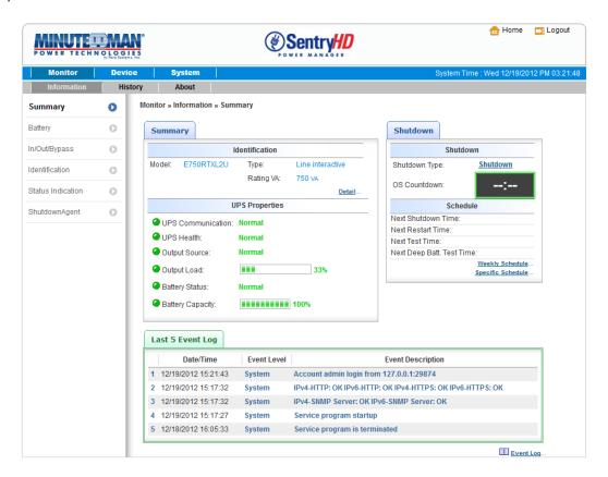
**Identification :**Affiche les informations sur le modèle, le type et la puissance VA de l'onduleur. **Propriétés UPS :**Énumérez les principales propriétés de l'onduleur pour surveiller l'état de santé, de sortie et de la batterie de l'onduleur.
