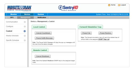
**Contrôle local**: Appuyez sur le bouton « Annuler le compte à rebours » pendant le processus d'arrêt du compte à rebours pour arrêter le compte à rebours. Appuyez de nouveau sur le bouton pour reprendre le processus d'arrêt. En plus de sélectionner l'élément de menu Reprendre le compte à rebours pour continuer le processus de compte à rebours, il démarrera également un nouveau processus de compte à rebours.
